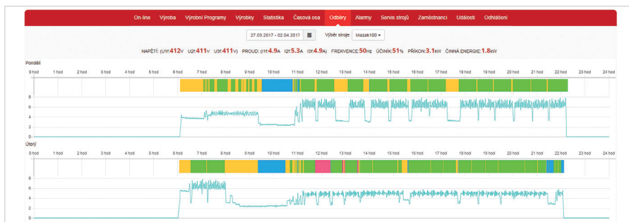
Obrazovka časové osy stavu výrobního stroje včetně monitoringu příkonu elektrické energie
