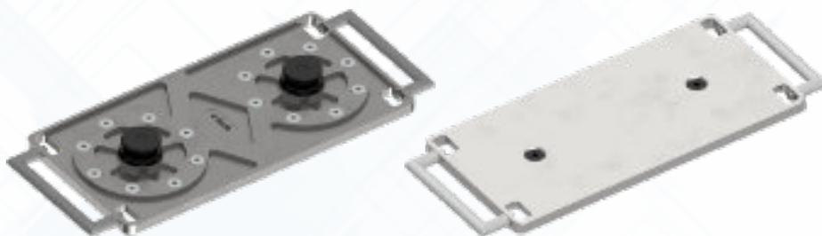
Univerzální výměnná paletka pro 2 upínací hnízda NES-t pro upnutí přípravku nebo jiného upínacího zařízení v upínací základně UZV-T obráběcího stroje. Je vybavena madly pro usnadnění manipulace. Provedení z oceli nebo vysokopevnostního hliníku. Ve verzi + je ocel přesně zabroušená a obsahuje kalené dotyky.
