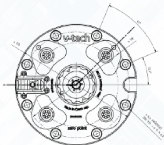
Základní prvek upínacího systému ZEPO-v, pro použití v aplikacích průmyslové automatizace. Oproti standardnímu upínači je vybaven systémem ofuku dosedacích ploch a senzorem odepnutí a přípravou airsensingu. Unikátní samosvorný mechanismus zajišťuje stabilitu upnutí i při odpojení tlakového média. Speciální modul pro zabudování do upínacích základen automatické paletizace.
