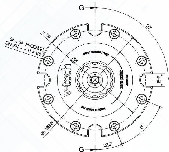
Základní prvek upínacího systému ZEPO-v, vhodný pro rozmanité frézovací operace. Vyniká extrémní upínací silou a kompaktním provedením. Unikátní samosvorný mechanismus zajišťuje stabilitu upnutí i při odpojení tlakového média. Univerzální modul pro zabudování do standardních jakož i na míru vyráběných upínacích základen. V kombinaci s vhodnou paletkou (PLTxxx) tvoří ideální sestavu jakéhokoliv obráběcího centra.
